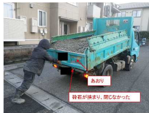
碎石投入後、あおりに碎石が挟まり、あおりが閉じなかった。
