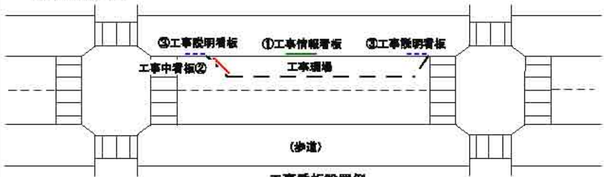
工事看板設置例
