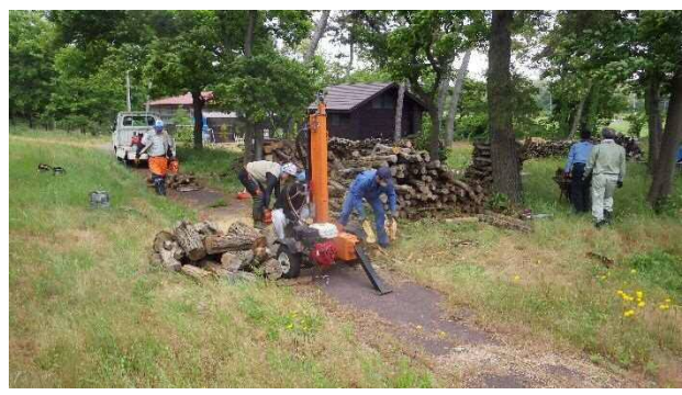
短くした木を薪割機で薪にしました。
