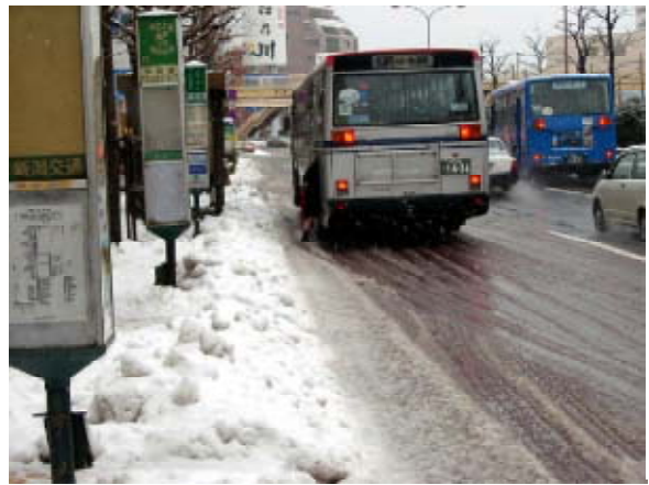
写真3.14 除雪した雪の影響でバスがバス停に寄ることができない
