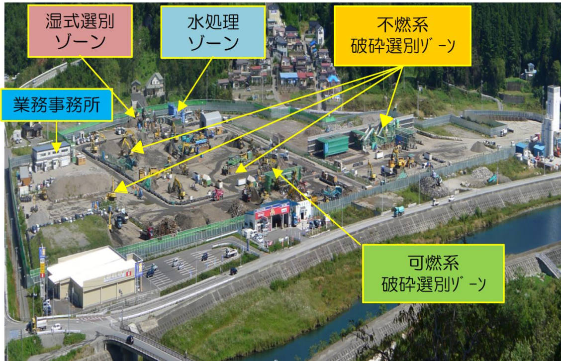
図 2-6-2 二次仮置場施設配置計画例
