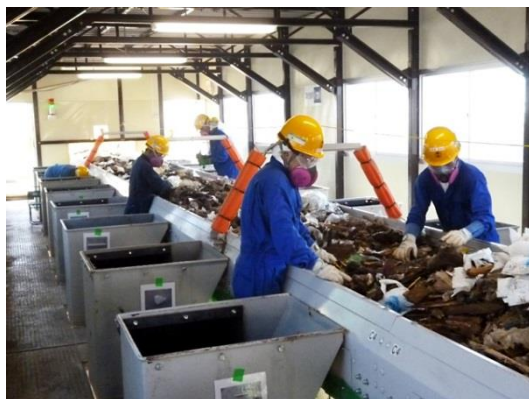
ベルトコンベアラインによる手選別
