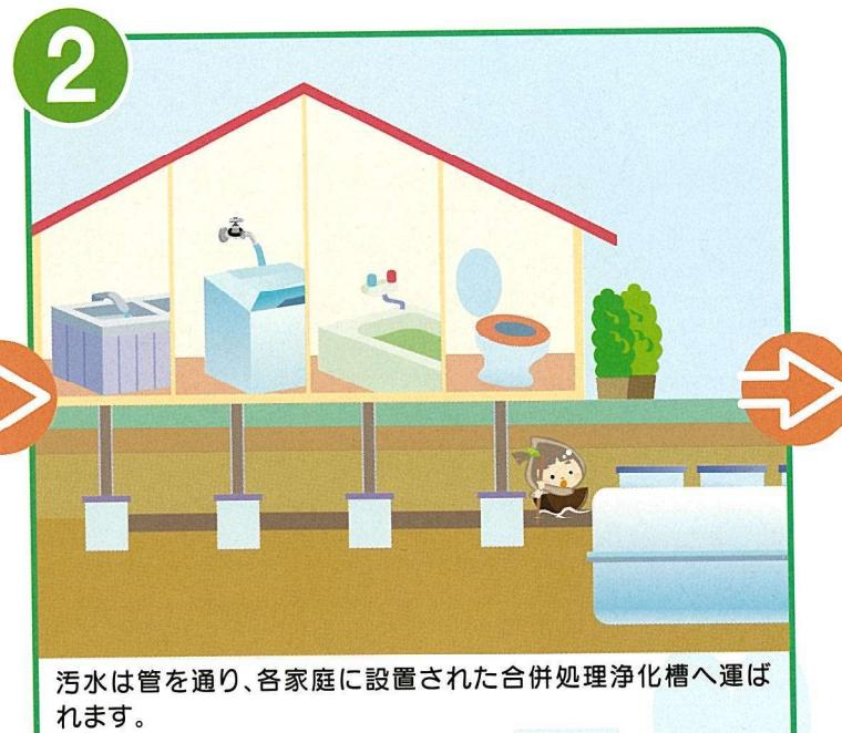
汚水は管を通り、各家庭に設置された合併処理浄化槽へ運ばれます。
