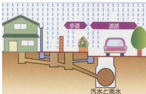
下水の排除方式（合流式）
