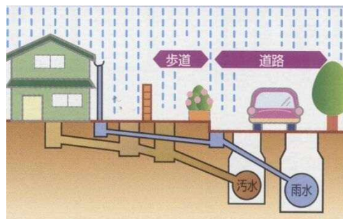
下水の排除方式（分流式）
