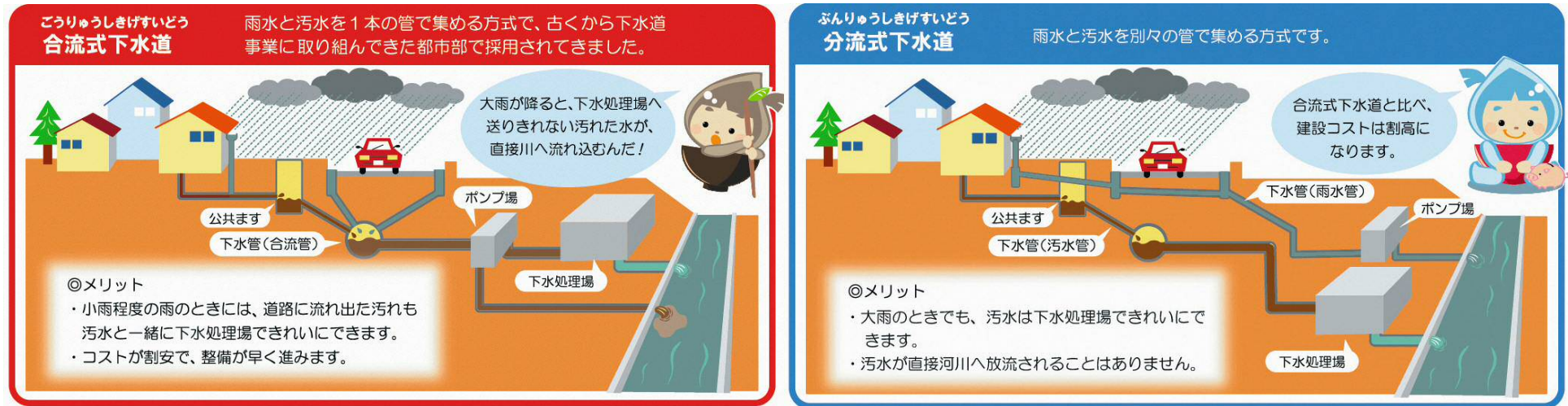
図1 合流式下水道と分流式下水道
