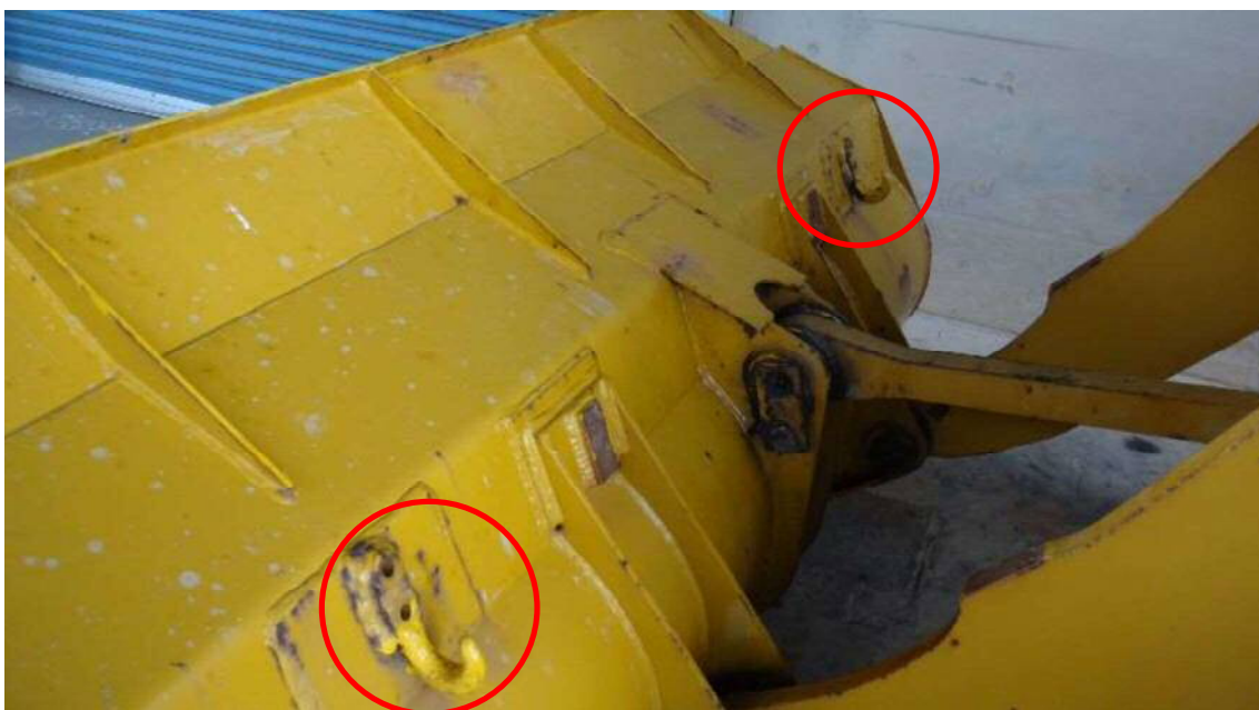
③吊り上げ用フック治具 2か所
