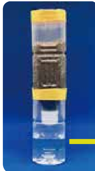
①沈でん実験でキレイになった「ろ過前の水①」をミニろ過池の上から砂が崩れないように静かにゆっくりと入れます。
