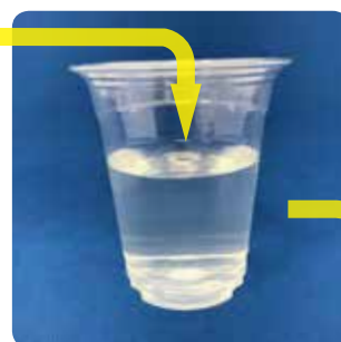
②30分程度するとカップの底によごれが沈みます。上澄みのキレイな水をろ過実験用にカップ中(400ml)に移します。
