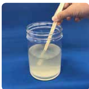
①よごれた川の水500mlに重曹液の上澄みを上澄み(2.5ml)入れてわりばしで数秒間かき混ぜます。次にミョウバン液を上澄み(2.5ml)入れて激しく1分間混ぜます。(1秒間に3~4回転程度)最後にゆっくりと5分間混ぜます。(4秒に1回転程度)ゆっくりと長くかき混ぜて、小さなよごれのかたまりをたくさん作りましょう。
