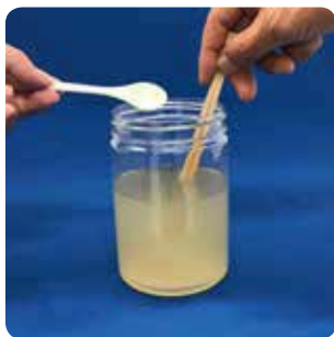
①よごれた川の水500mlに重曹液の上澄みを上澄み(2.5ml)入れてわりばしで数秒間かき混ぜます。次にミョウバン液を上澄み(2.5ml)入れて激しく1分間混ぜます。(1秒間に3~4回転程度)最後にゆっくりと5分間混ぜます。(4秒に1回転程度)ゆっくりと長くかき混ぜて、小さなよごれのかたまりをたくさん作りましょう。
