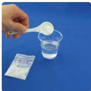
②カップ小にぬるま湯を入れて小さじ2杯(約10g)のミョウバンを入れてよくかき混ぜます。ミョウバンは溶け残るくらいで大丈夫です。
