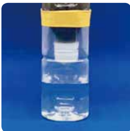
②砂と砂利の間を通過して下のキャップから透明な水が落ちてくるのでゆっくりと観察しましょう。
