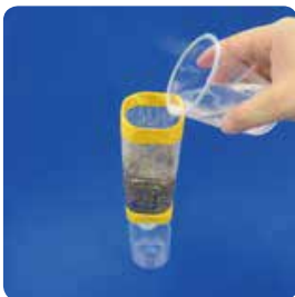
①沈でん実験でキレイになった「ろ過前の水①」をミニろ過池の上から砂が崩れないように静かにゆっくりと入れます。
