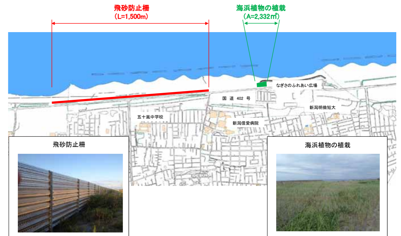
▽図Ⅳ-⑦ 飛砂防止柵設置及び海浜植物植栽の現状
